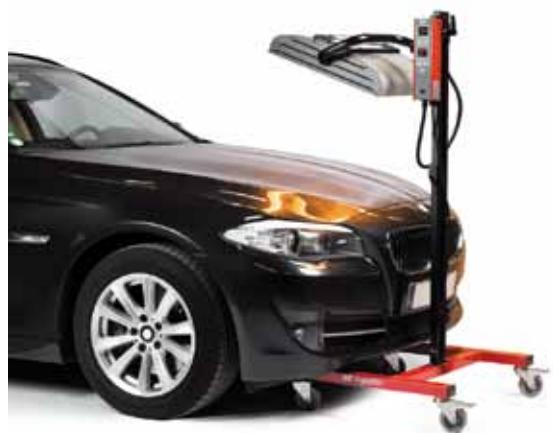
赤外線ランプの寿命を縮める主な要因は、過熱とほこりです。IRT 3PrepCureのカセットは、過熱対策には強力な冷却ファンを、ほこり対策には最新の微粒子フィルターを装備しており、ランプの長寿命化を実現しています
